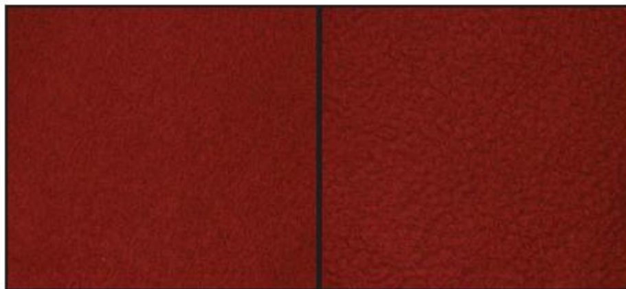
شکل پ ۲- نمونه‌ای از تصویر نمدی شدن پارچه خارزنی شده (پشت پارچه)، سمت چپ: قبل از آزمون، سمت راست: بعد از آزمون
