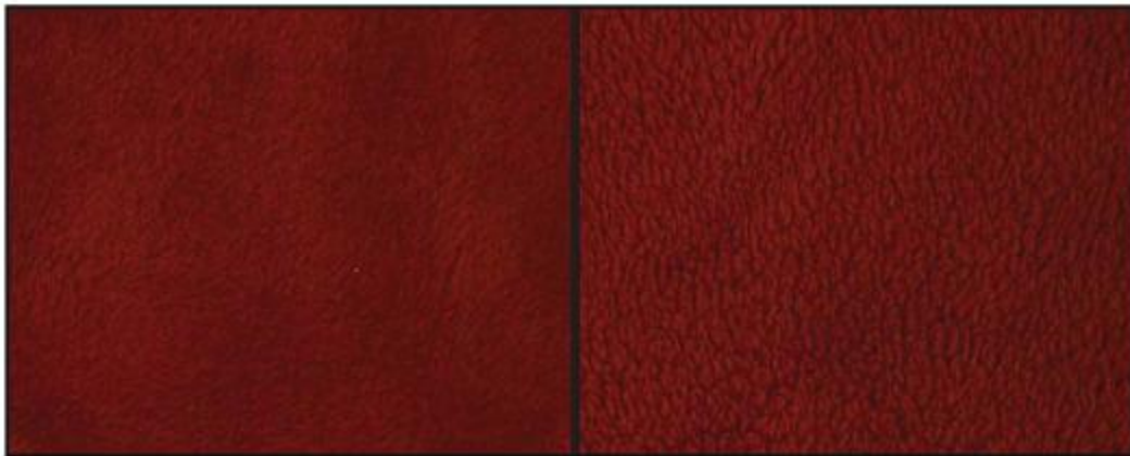
شکل پ ۱- نمونه‌ای از تصویر نمدی شدن پارچه خارزنی شده (روی پارچه)، سمت چپ: قبل از آزمون، سمت راست: بعد از آزمون
