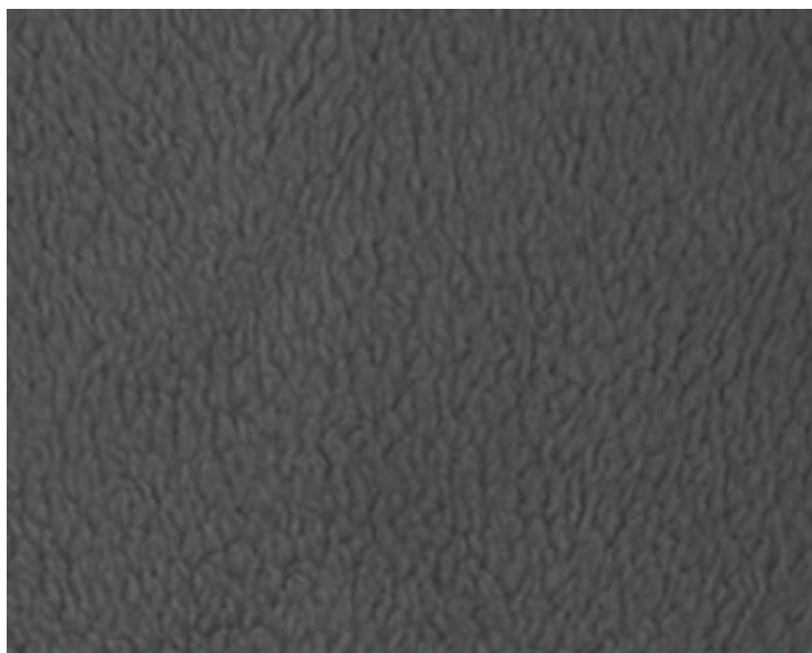
شکل ۱ – مثالی از ظاهر پارچه پرزدار نمدی شده
