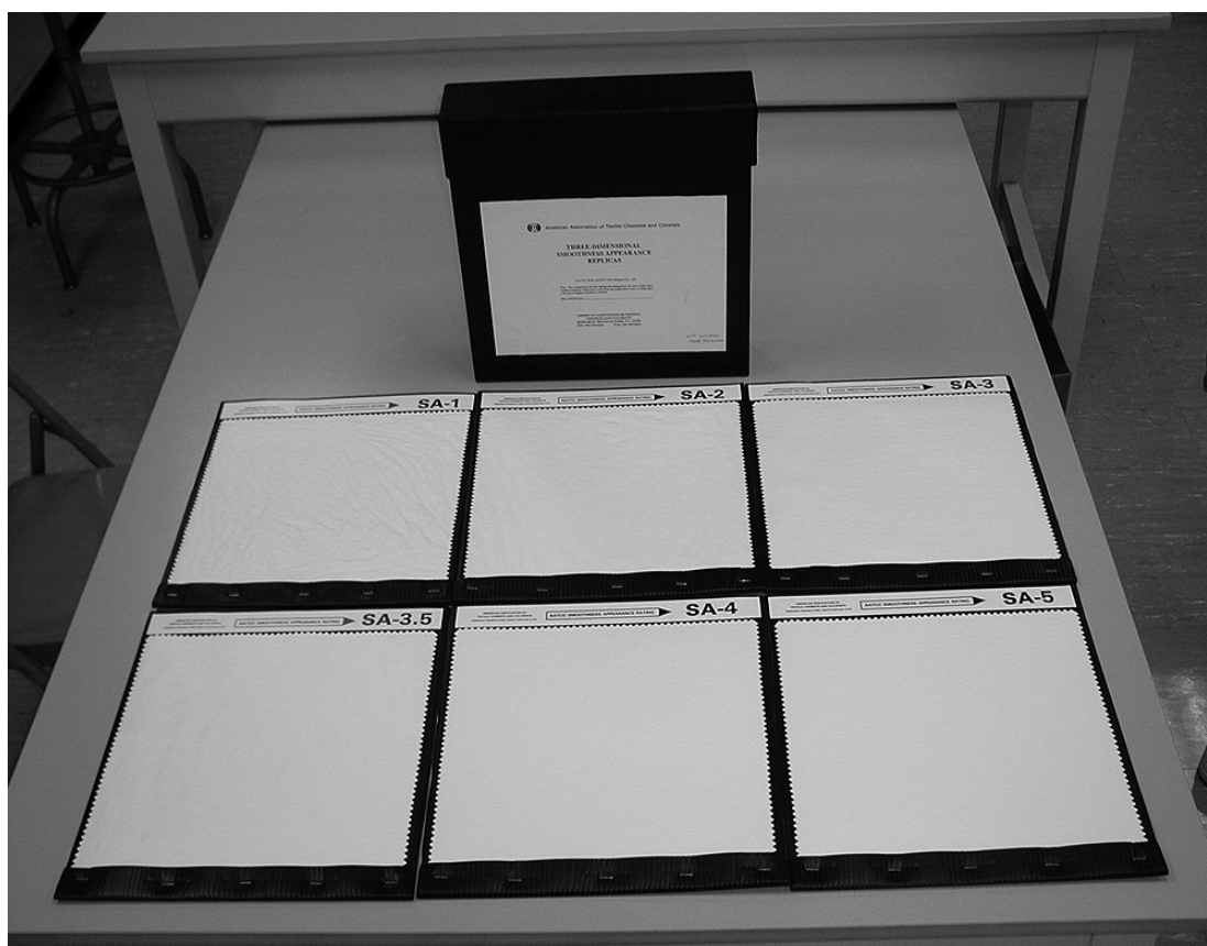
شکل ۲ - معیارهای سه‌بعدی AATCC برای صافی ظاهر پارچه
